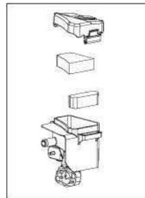
2. Inspeccione el filtro de aire. Limpie el filtro de aire sucio con agua tibia y jabón suave. Permita que el filtro de aire se seque completamente antes de volver a instalarlo.
