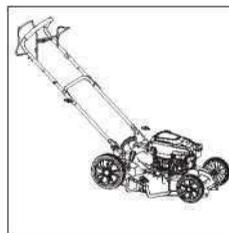
2. Despliegue el mango superior y fíjelo al mango inferior usando las perillas grandes y los tonillos en cada lado
