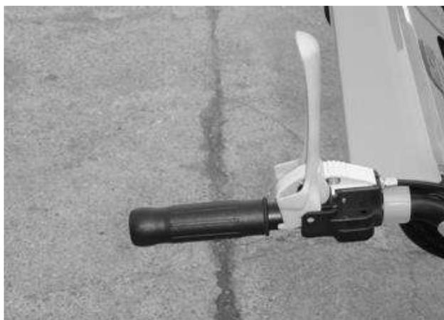
Fig. 9 Palanca de embrague del rotor
