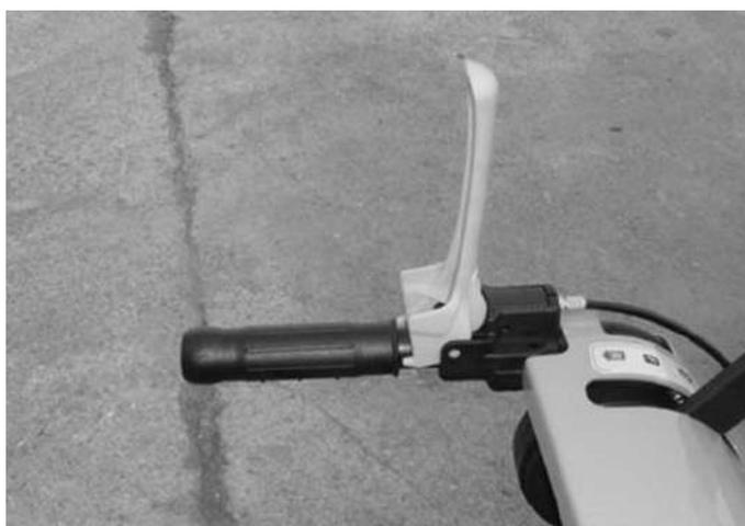
Fig. 8 Palanca del embrague de alimentación
