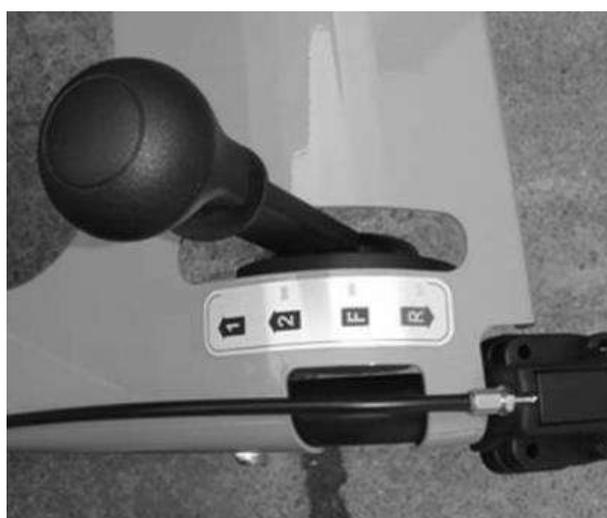
Fig. 10 Palanca de cambios
