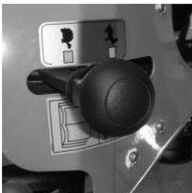
Fig. 11 Palanca de la reductora de marchas
