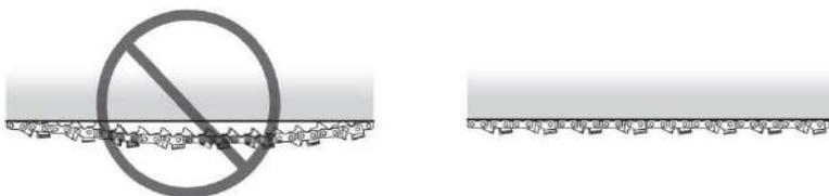
• **Mantenga el equipo de corte bien lubricado y con un mantenimiento adecuado.** Una cadena mal lubricada es más probable que se rompa y provoque un mayor desgaste de la barra, la cadena y el piñón de arrastre.
