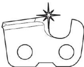
• **Mantenga el ajuste correcto del calibrador de profundidad.** Siga las instrucciones y utilice la holgura recomendada para el calibrador de profundidad. Una holgura grande aumenta el riesgo de retroceso.
