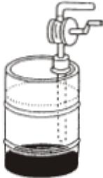
El agua y materia extraña será depositada en la posición más baja en el barril. Poner el tubo de succión en el cañón en el lugar con una profundidad media del cañón, bombee el aceite limpio en la posición superior en el cañón.
