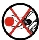
No corte ramas más allá del diámetro especificado indicado. No saque la hoja de las ramas para cortar. Dañada debido a un uso inadecuado. La posición de la hoja rota es inferior a 20 mm (desde el borde hasta el lado roto, vea la imagen).
